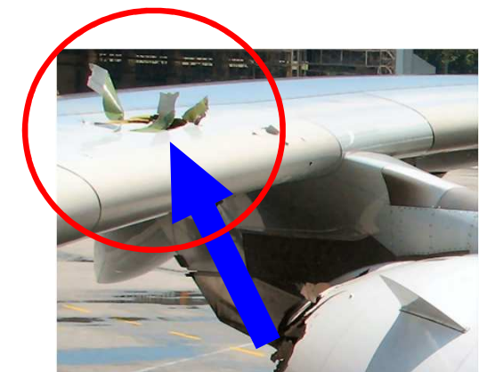
Bsp. Schaden Treibwerk
