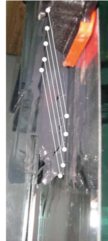
Bild 3.6: Schubbruch einer H-Probe; Bild: S. Koch Bild 3.7: Idealisiert eingezeichnete Makromoleküle vor dem Bruch
