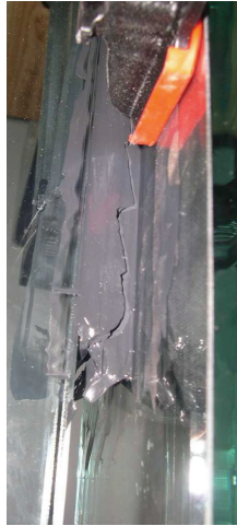
Bild 3.6: Schubbruch einer H-Probe; Bild: S. Koch Bild 3.7: Idealisiert eingezeichnete Makromoleküle vor dem Bruch
