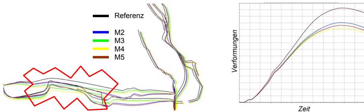
Bild 11: a) Deformationen am Beispiel eines Schnitts durch die Fahrzeugquerachse ( t=60\text{ms} ) b) Verformung-Zeit-Verlauf eines ausgesuchten Punktes in der B-Säule
