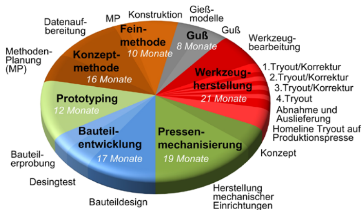
Bild 1: Produktionszeiten und Kostenverteilung am Beispiel eines Seitenwandrahmens nach [3]
